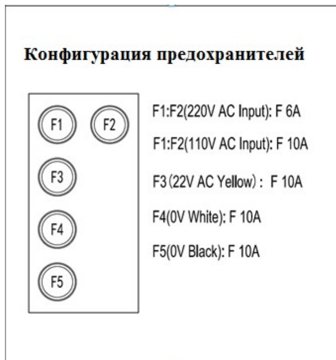
Рис. 5. Блок предохранителей напольного блока подключения
